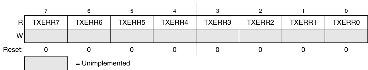
Figure 10-18. MSCAN Transmit Error Counter (CANTXERR)
